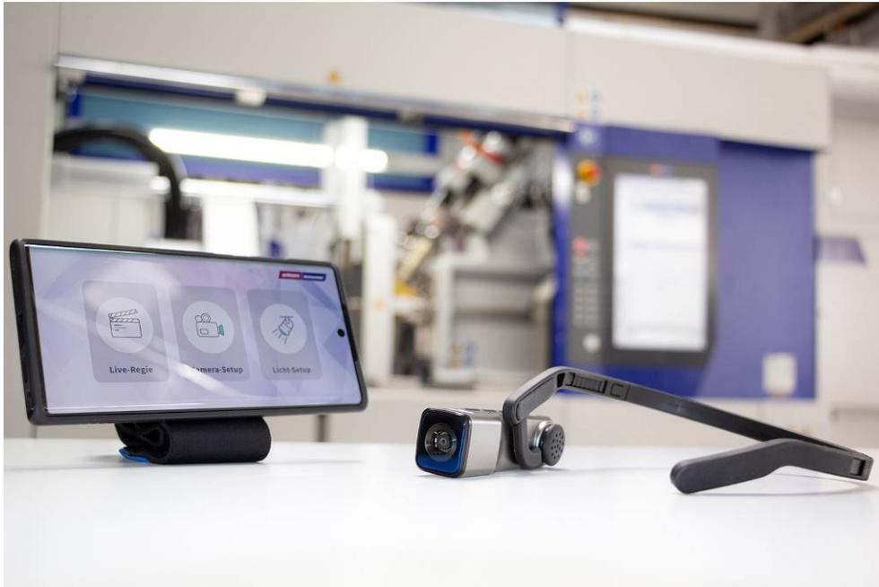
**Abb. 1:** Kopfkamera mit Steuerungs-App via Smartphone
