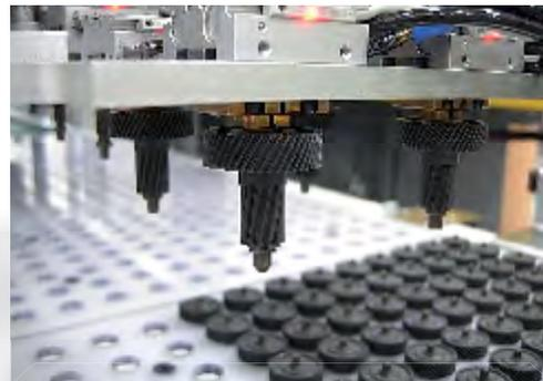
Les pique carottes et les robots à servomoteurs sont omniprésents dans la transformation des matières plastiques. Ils sont utilisés pour des opérations de pose d'inserts et de prise de pièces et sont indispensables dans tous les processus de l'injection plastique.
