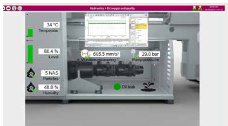
Exemple: surveillance du système hydraulique
