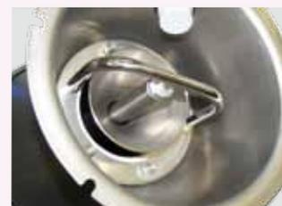
La cloche de décharge pilotée par vérin pneumatique garantit une grande fiabilité grâce à une étanchéité parfaite à chaque cycle de transport. La conception étanche assure également un fonctionnement sans poussière dans la trémie machine.
