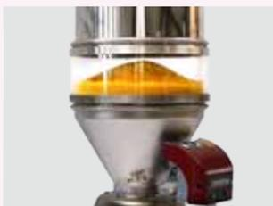
La série **FEEDMAX CT** (Clear Tube) rend visible le flux matière quel que soit l'angle de vue. La section en verre haute qualité est conçue pour des charges élevées et un flux matière optimal.
