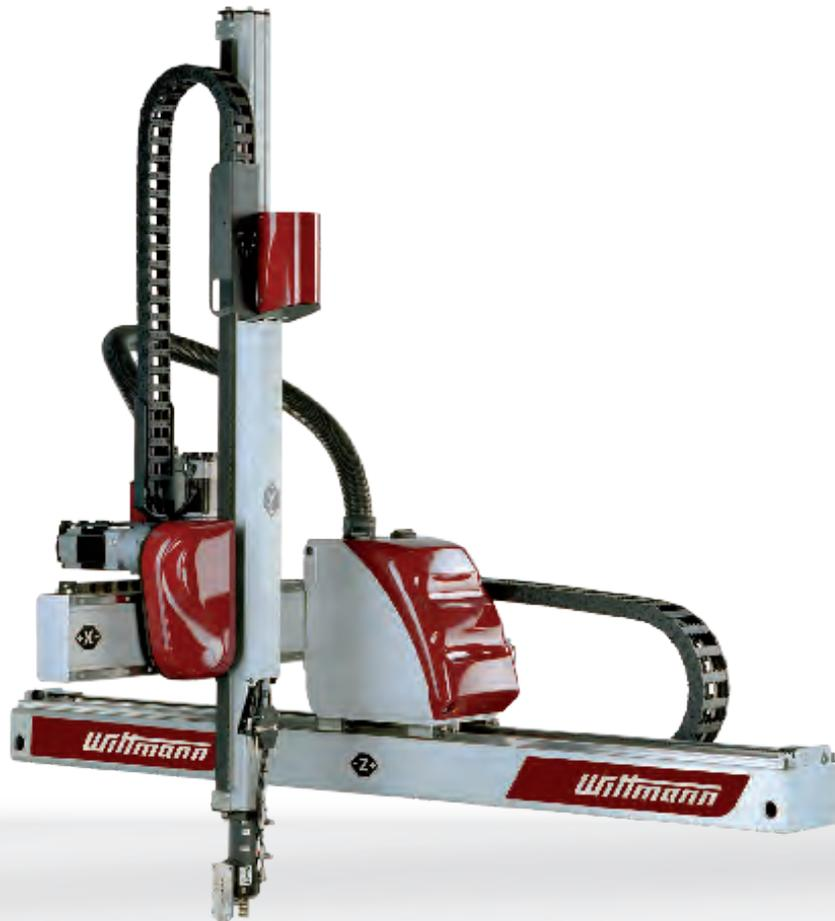
Technologie auf der Höhe der Zeit: WITTMANN Servoroboter mit als Stahlträgern ausgeführten Horizontalachsen und Querhubaufbau aus massivem Aluminiumprofilrohr.
