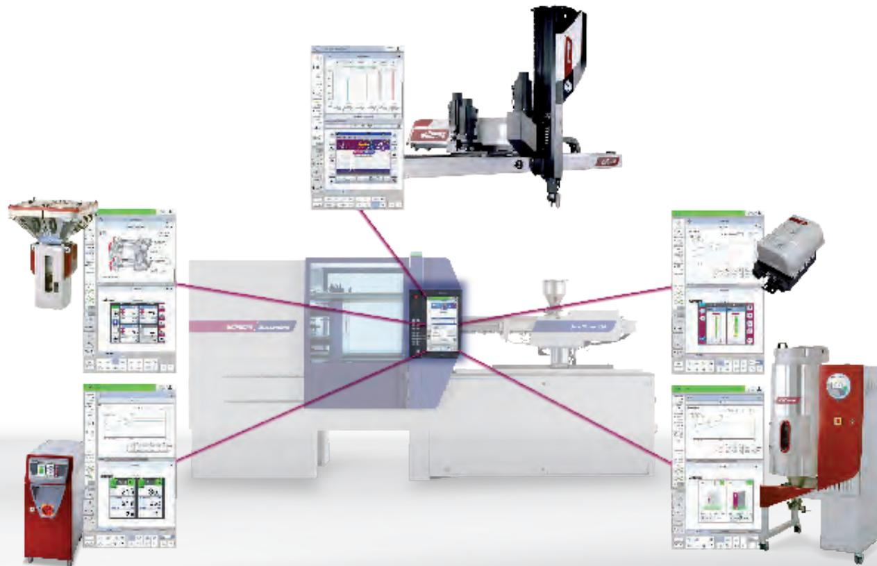
*Schematische Darstellung: Integration von Peripheriegeräten in die Maschinensteuerung*
