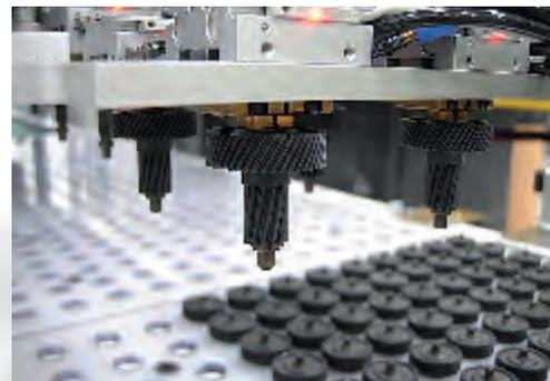
Angussentnahmegeräte und Servoroboter für Einlegevorgänge und die Teileentnahme sind aus dem Spritzgießprozess nicht mehr wegzudenken.
